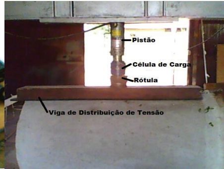
Figura VIII – Sistema usado para aplicar o carregamento (Fonte: Queiroz - 2012)
