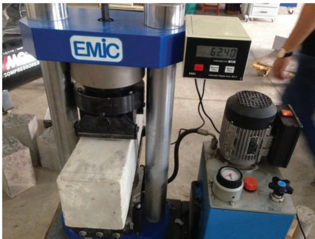
**Figura VI:** Modelo de ensaio de tração na flexão
