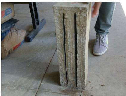
**Figura IV:** Criação dos cortes nas vigas.
