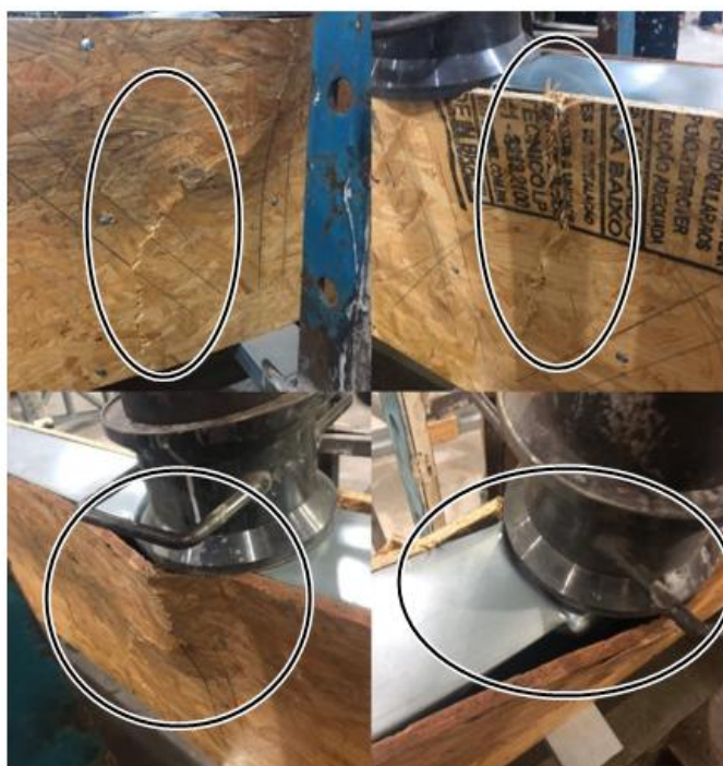
Figura 10: Deformações e rompimento da treliça 2.
