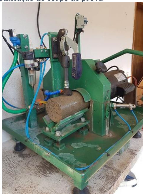
Figura 1 - Processo de retificação do corpo de prova
