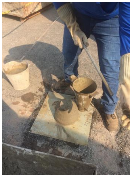
Figura 01 - Retirada do molde de tronco de cone
