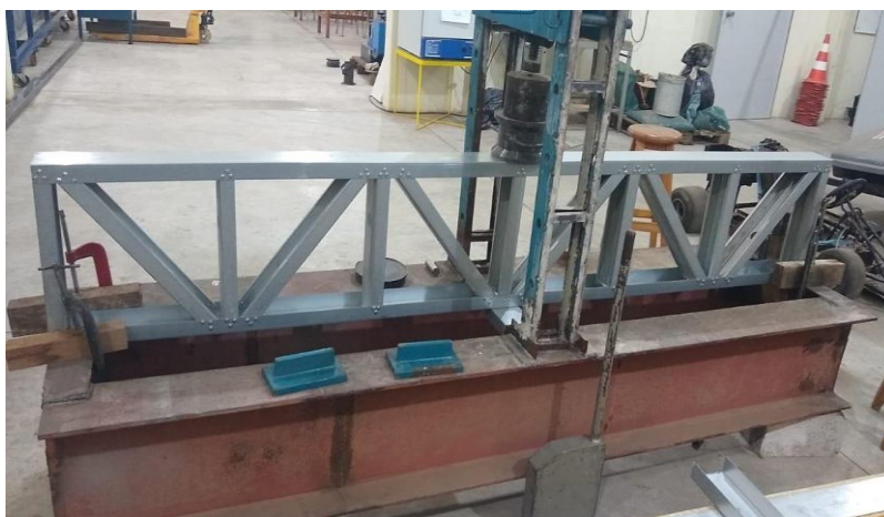
Figura 7: Treliça posicionada sobre a prensa hidráulica para realização do ensaio.
