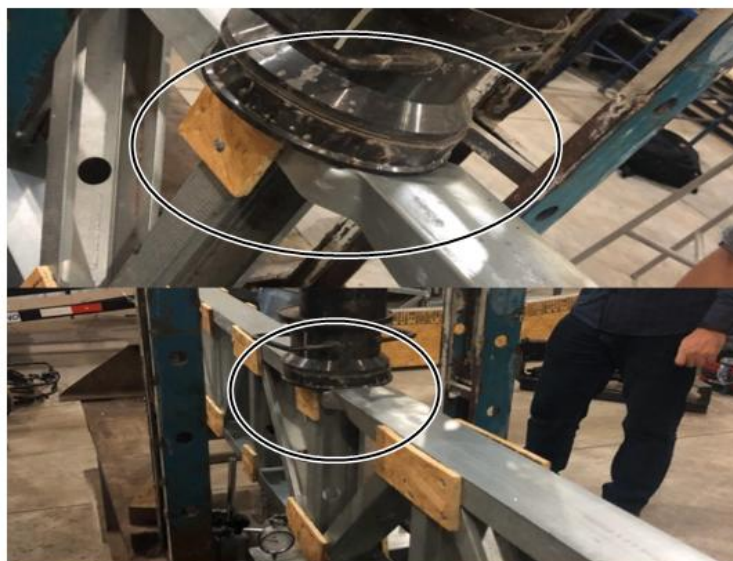
Figura 11: Deformação da estrutura após carga aplicada.
