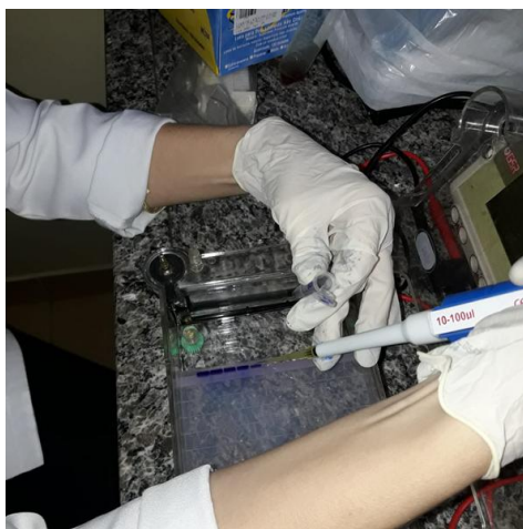
Figura 7.4: Aplicação das amostras nos poços presentes no gel de agarose. No que elas estão azuis devido ao azul de bromofenol presente no tampão da amostra.
