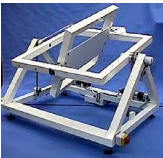
Figura 2 - Clinostat com dois eixos de rotação. Fonte: NASA.
