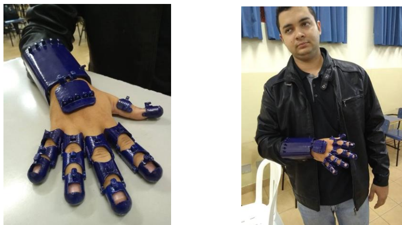
Figura 8 – Exoesqueleto de mão, desenvolvido em impressora 3D (material ABS). Fonte: Autores.
