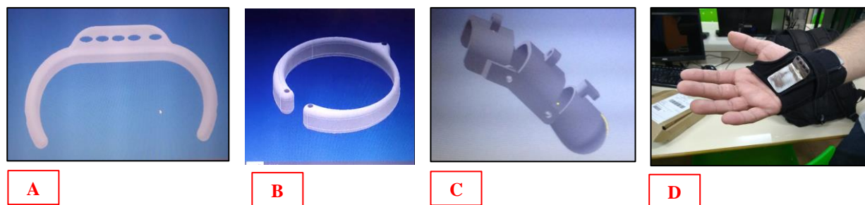
Figura 09 – Soluções propostas. A) anel para tracionar os fios (tendões). B) Anel para fixar os tendões. C) Suporte para encaixar os dedos e tracionar os fios (tendões). D) Luva com suporte na palma para tracionar os fios (tendões).
