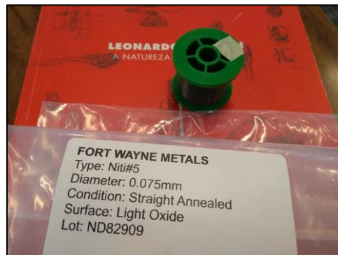
Figura 9 – Fio de Nitinol (shape memory alloy), doado pela empresa Fort Wayne Metals.
