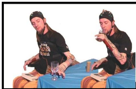
Figura 3 – Controle de prótese (mão biônica) através de uma interface cérebro-máquina. Fonte: PFURTSCHELLER et al., 2008.
