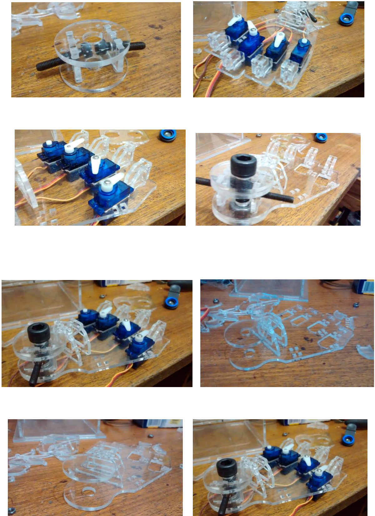
Figura 4 – Imagens de protótipo de mão biônica construída em acrílico, do projeto de iniciação científica “Adaptação e automação de prótese biônica de membro superior através de interface cérebro-máquina”. Fonte: autores.
