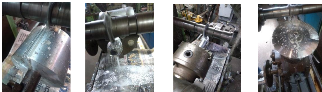
Figura 3 – Usinagem dos quatro tipos de engrenagens. Fonte: autores.
