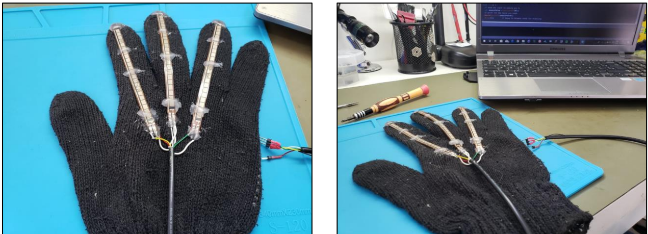
Figura 6 – Luva avatar (“avatar glove”), com os sensores flexíveis. Fonte: autores.
