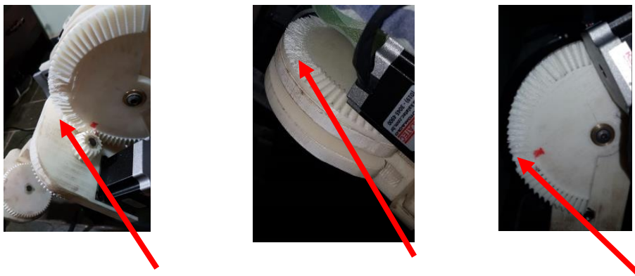
Figura 2 – Engrenagem cremalheira danificada após uso, devido ao percentual de preenchimento no processo de prototipagem em impressora 3D (ABS/PLA). Fonte: autores.
