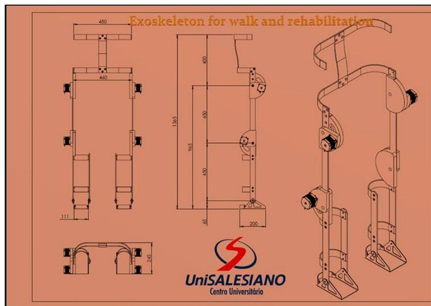
**Figura 25** – Exoesqueleto para membros inferiores, desenvolvidos por acadêmicos de Engenharia Mecânica. Fonte: autores.
