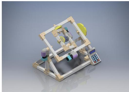
**Figuras 2 e 3** – Protótipo do Clinostat Tridimensional (projeção paralela ortogonal frontal direita e esquerda). Fonte: autores.
