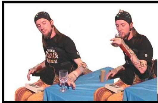
**Figura 3** – Controle de prótese (mão biônica) através de uma interface cérebro-máquina. Fonte: PFURTSCHELLER et al., 2008.
