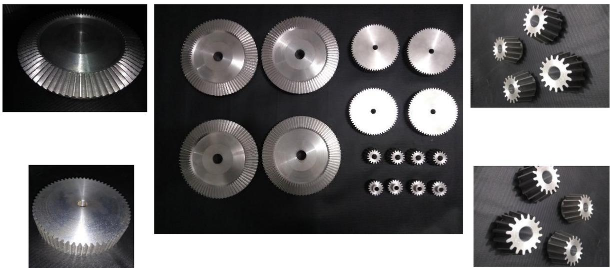
**Figura 4** – Engrenagens usinadas em alumínio. Fonte: autores.
