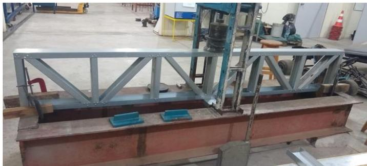
**Figura 7:** Treliça posicionada sobre a prensa hidráulica para realização do ensaio.
