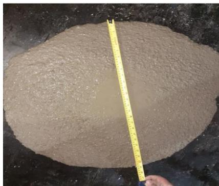
**Figura 6-** Resultados do ensaio de espalhamento. **Fonte:** Autor**Tabela 4:** Resultados do ensaio de espalhamento
