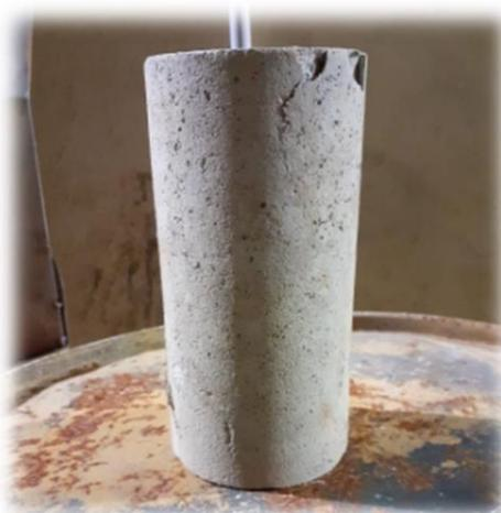
**Figura 13** – Ruptura causada por esmagamento. **Fonte:** Autor
