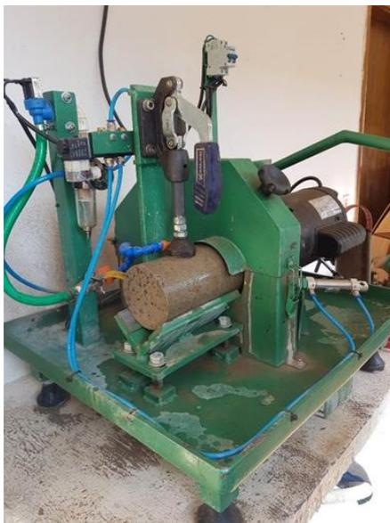
**Figura 1** - Processo de retificação do corpo de prova
