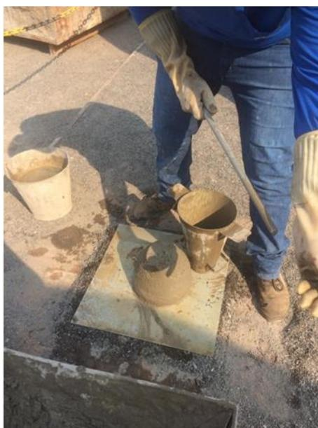
**Figura 01** - Retirada do molde de tronco de cone
