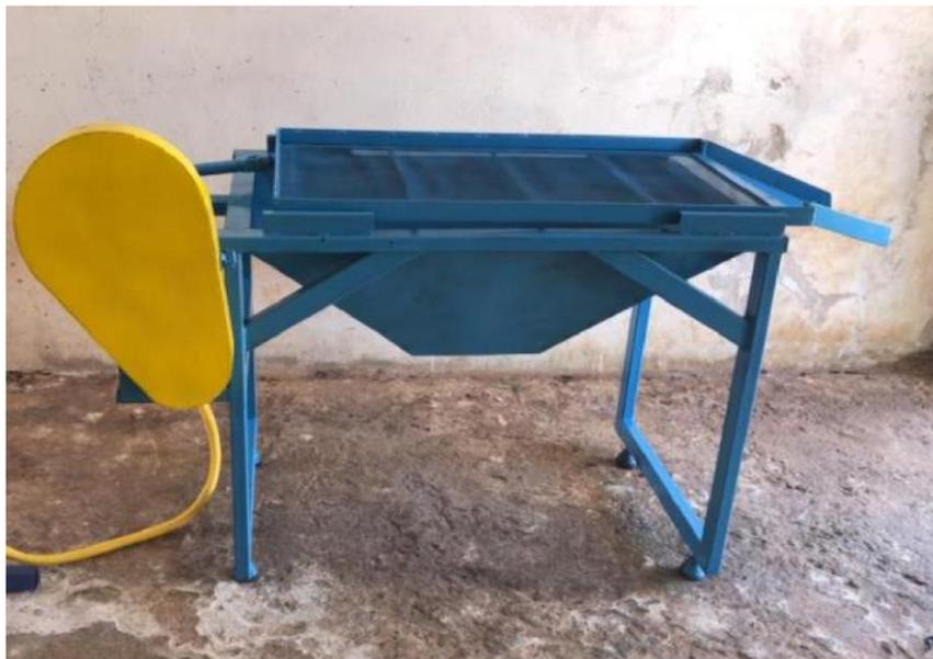
Figura 3: Peneira elétrica para separação de sólidos finalizada Fonte: Os autores, 2021.
