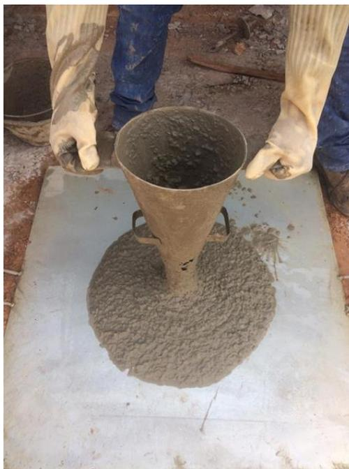
**Figura 02** - Desmoldagem do concreto autoadensável
