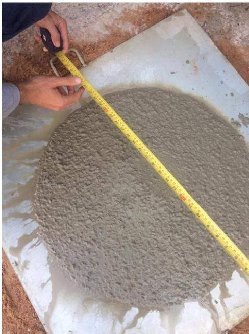
**Figura 03** - Medidas obtidas através do diâmetro do concreto na placa
