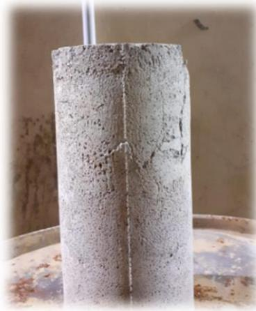
**Figura 12** – Ruptura causada por esmagamento. **Fonte:** Autor
