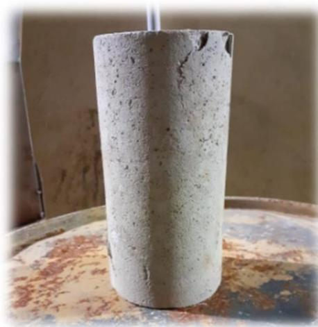
**Figura 13** – Ruptura causada por esmagamento. **Fonte:** Autor
