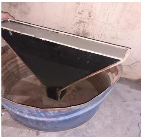
**Figura 8-** Funil - V realizando ensaio. **Fonte:** Autor
