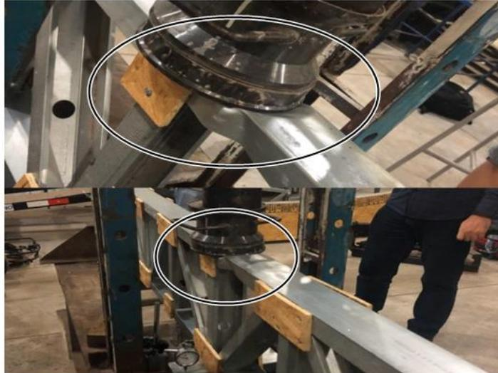
**Figura 11:** Deformação da estrutura após carga aplicada.
