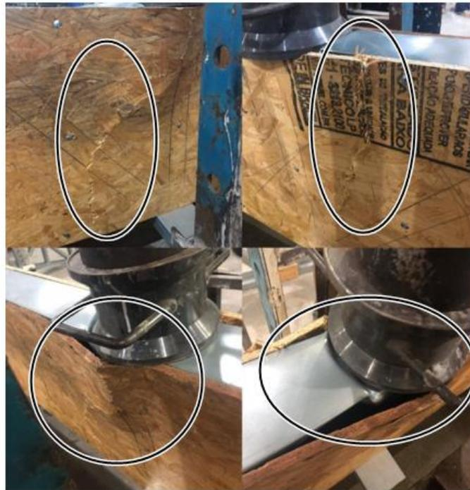
**Figura 10:** Deformações e rompimento da treliça 2.
