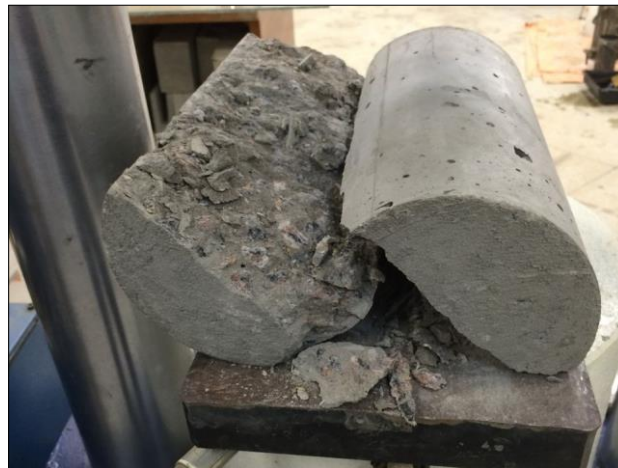
Figura 04 – Compressão diametral: sentido da fissura
