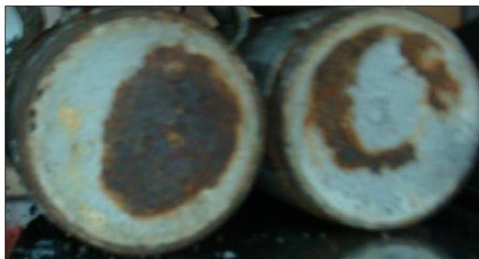
**Figura 11** - Corpo de prova de argamassa polimérica com sinais de oxidação. Fonte: Rocha (2012).
