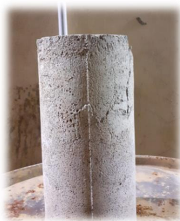
Figura 12 – Ruptura causada por esmagamento. Fonte: Autores.
