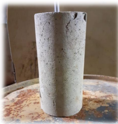
Figura 13 – Ruptura causada por esmagamento. Fonte: Autores.
