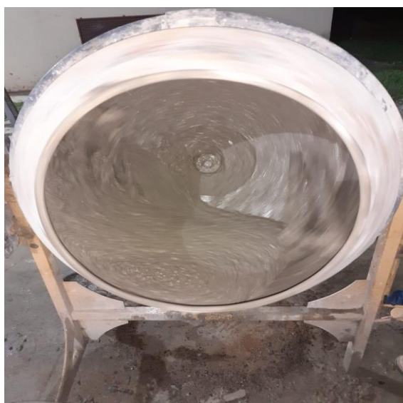
Figura 5- Betoneira em produção. Fonte: Autores.
