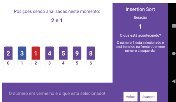
Figura 5 - Interface de usuário apresentando uma iteração da simulação do Insertion Sort.
