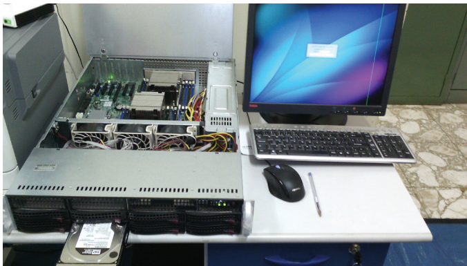
Figura 5 - Servidor Supermicro com HD ejetado
