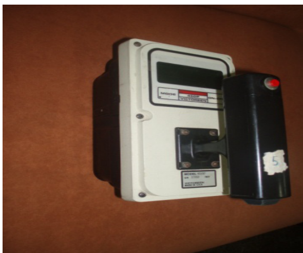
Figura 2: Câmara de ionização 450P da Victoreen
