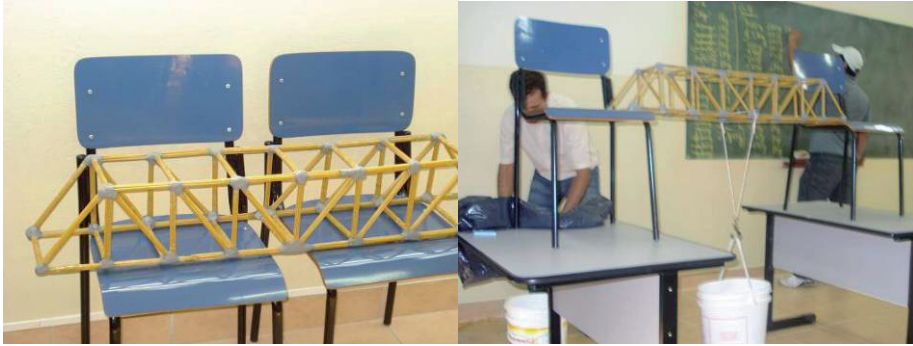
Figura 6 – (a) Modelo da ponte do Grupo 4; (b) Ponte apoiada e recebendo carga.
