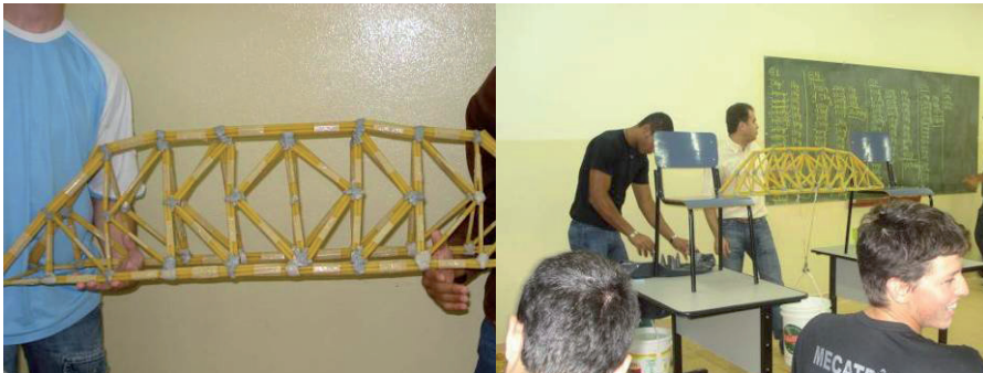
Figura 3 – (a) Modelo da ponte do Grupo 1; (b) Ponte apoiada e recebendo carga.
