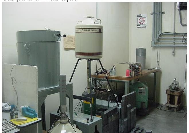
Figura 13 - Imagem do detector de Iodeto de Sódio (NaI)
