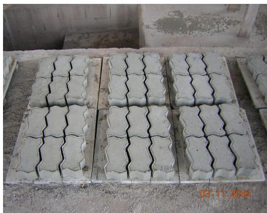
Figura 3: Blocos de concreto sobre os paletes de madeira.
