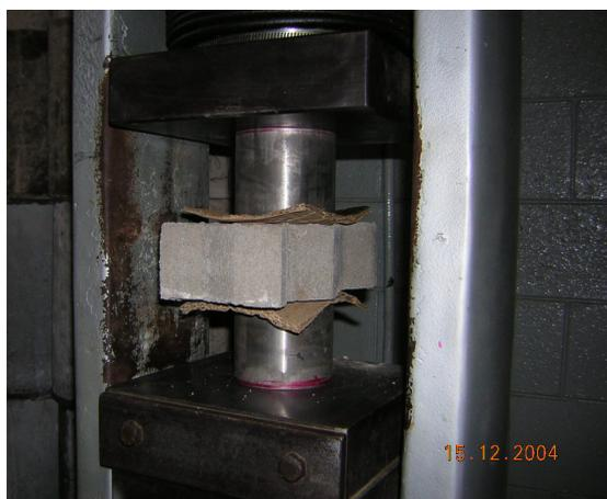
Figura 5: Bloco na prensa para ensaio de compressão.
