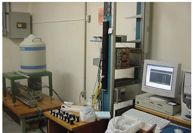
Figura 14 - Imagem do detector de Iodeto de Sódio (NaI)
