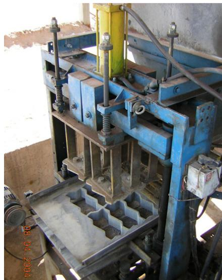
Figura 4: Detalhe da caixa de prensagem da vibro-prensa semi-automática.
