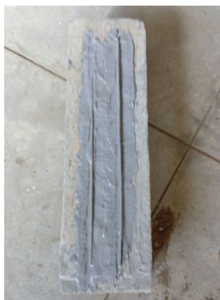
Figura V: Embutidura de laminados metálicos em vigas.
