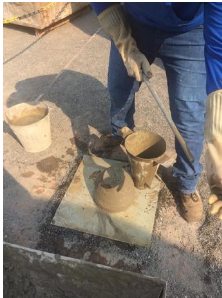
Figura 01 - Retirada do molde de tronco de cone
