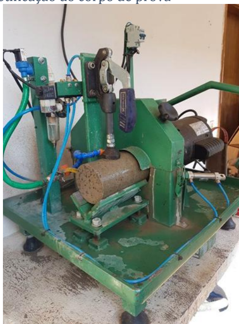
Figura 1 - Processo de retificação do corpo de prova
