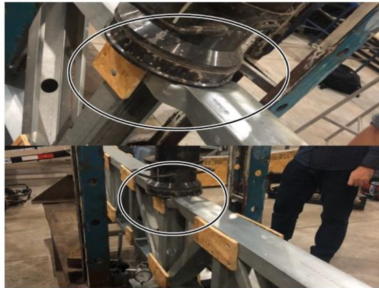
Figura 11: Deformação da estrutura após carga aplicada.
