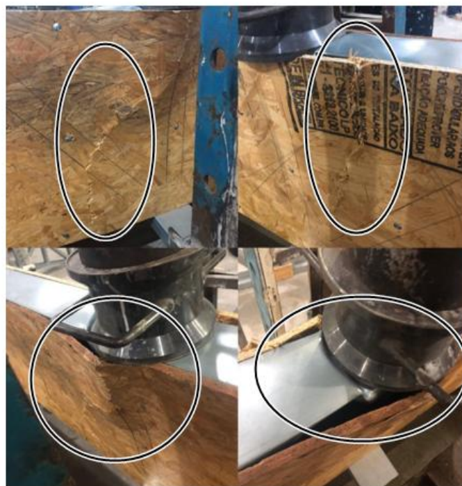
Figura 10: Deformações e rompimento da treliça 2.
