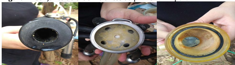
Figura 1: Conjunto de ordenha antes da primeira limpeza.
