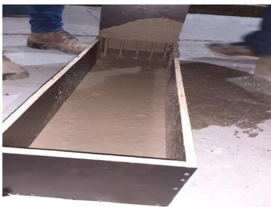
**Figura 10 -** Caixa “L” durante o ensaio. Fonte: Autores.
