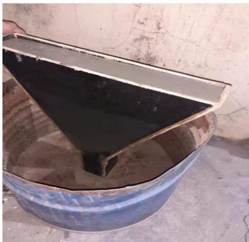
**Figura 8-** Funil - V realizando ensaio. Fonte: Autores.
