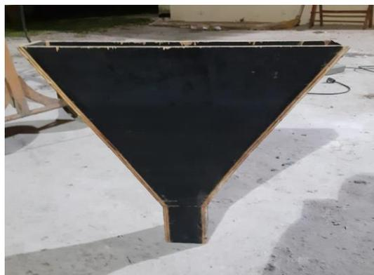
**Figura 7-** Funil - V fabricado. Fonte: Autores.
