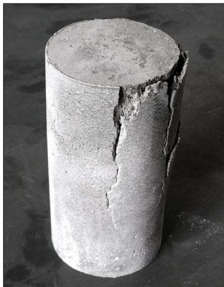
**Figura 03**– Ruptura do tipo “F”.
