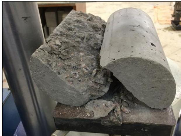
**Figura 04** – Compressão diametral: sentido da fissura
