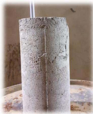
**Figura 12** – Ruptura causada por esmagamento. Fonte: Autores.
