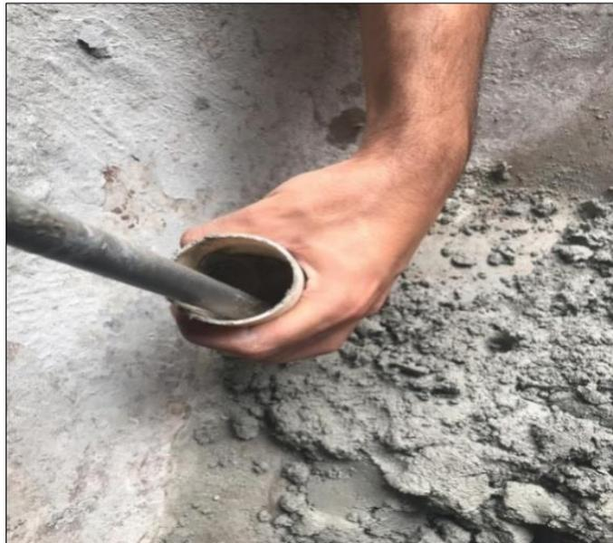
**Figura 8** - Adensamento da argamassa com 28 golpes por camada. Fonte: Autores.
