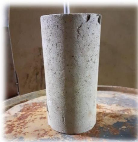
**Figura 13** – Ruptura causada por esmagamento. Fonte: Autores.
