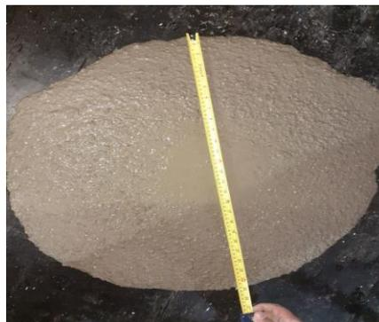
**Figura 6-** Resultados do ensaio de espalhamento. Fonte: Autores.
