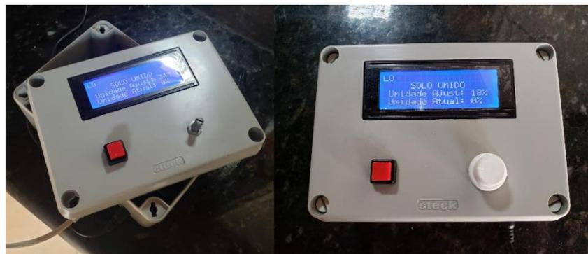
**Figura 3** - Controlador do sistema. Fonte: autores.
