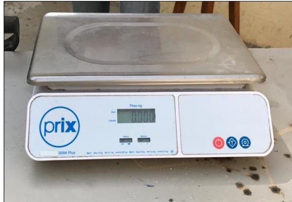
**Figura 3** - Balança para pesagem dos insumos. Fonte: Autores.
