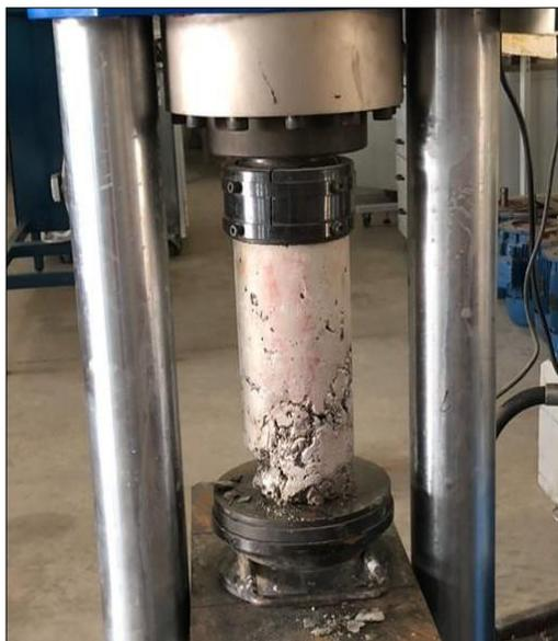
**Figura 02**– Ruptura do tipo “G”.
