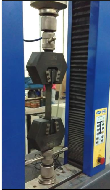
Figura 12. Corpo de prova modelo sendo submetido a tração. Fonte: autores.
