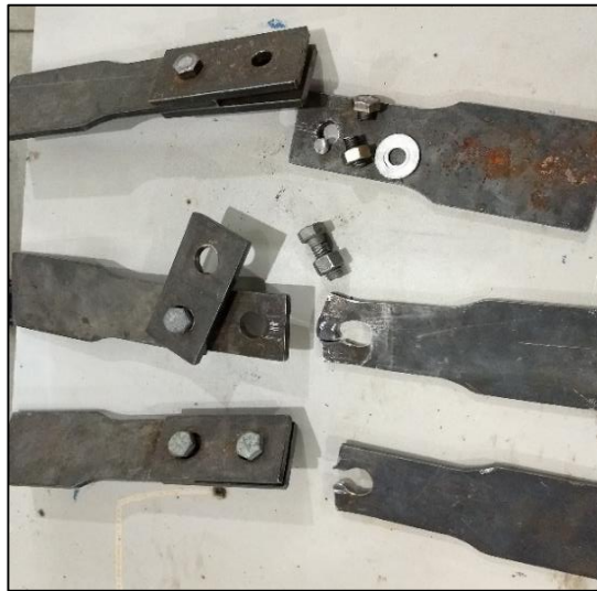
Figura 14. Corpos de prova parafusados rompidos. Fonte: autores.
