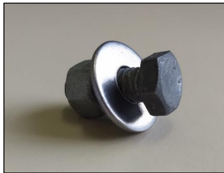
Figura 7. Parafuso comum fora da norma de estruturas. Fonte: autores.
