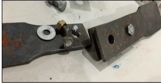
Figura 20. Corpo de prova parafusado com parafusos da norma. Fonte: autores.
