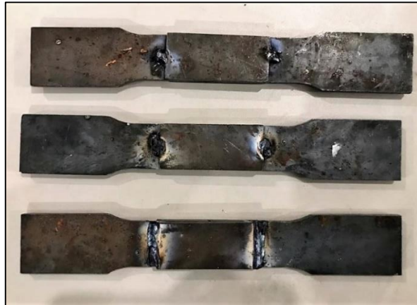
Figura 10. Corpos de prova soldados. Fonte: autores.
