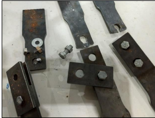
Figura 22. Comparação de rompimentos das ligações parafusadas. Fonte: autores.
