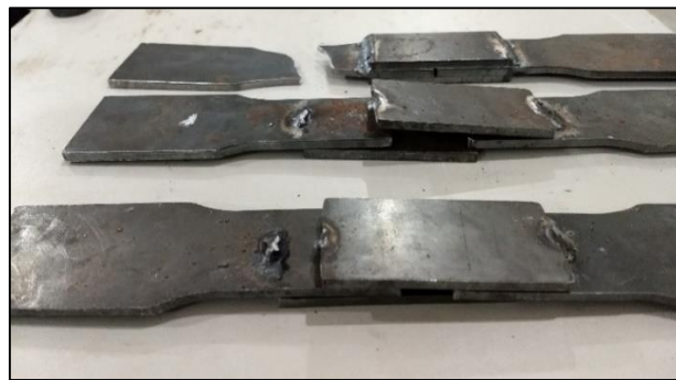
Figura 13. Corpos de prova soldados rompidos. Fonte: autores.
