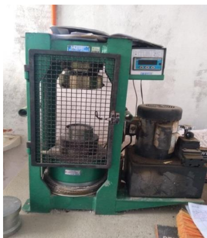
Figura 10: Prensa locada na obra
