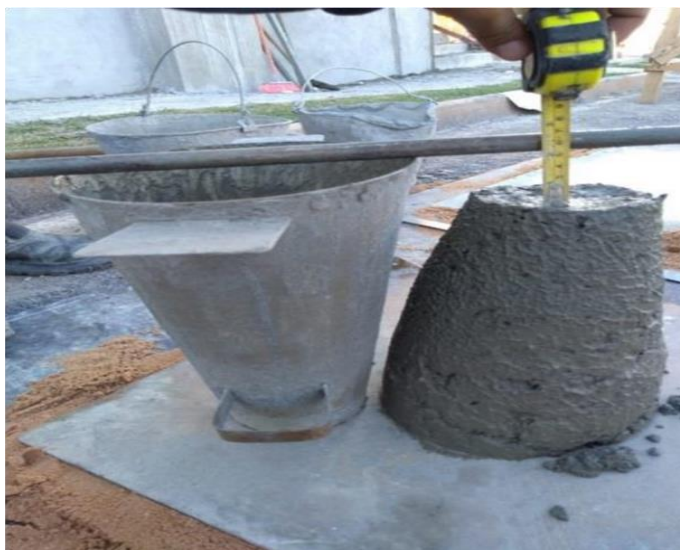
Figura 4: Cone e Slump. Fonte: Autores.
