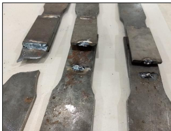
Figura 18. Comparação de rompimentos das ligações soldadas. Fonte: autores.
