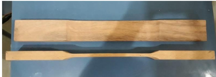
Figura 12 - Corpo de prova confeccionado para o ensaio de tração paralela às fibras.
