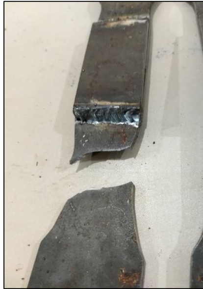
Figura 17. Corpo de prova soldado superdimensionado. Fonte: autores.
