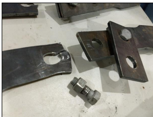
Figura 19. Corpo de prova o dimensionado com parafuso A307. Fonte: autores.
