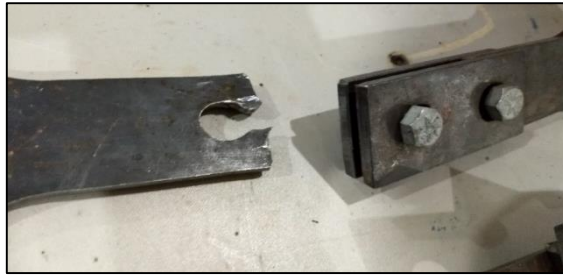
Figura 21. Corpo de prova submetido ao rasgamento. Fonte: autores.
