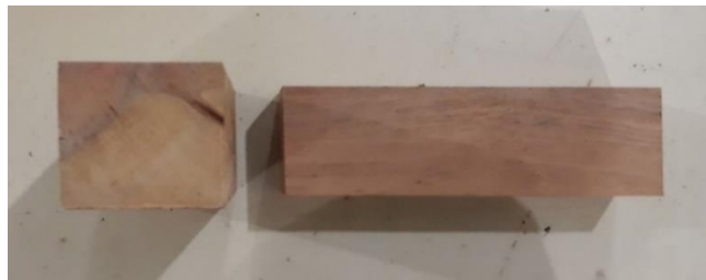
Figura 10 - Corpo de prova confeccionado para o ensaio de compressão paralela às fibras da madeira. Fonte: autores.
