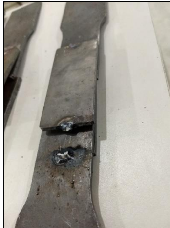
Figura 15. Corpo de prova soldado subdimensionado. Fonte: autores.
