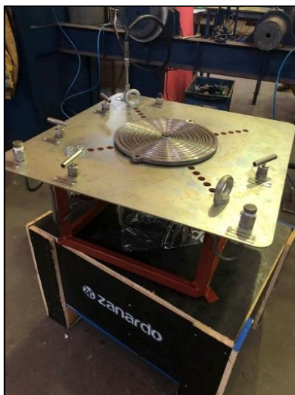
Figura 5 - A bancada fora da maleta para a realização do teste de hidrostático. Fonte: Próprio Autor.
