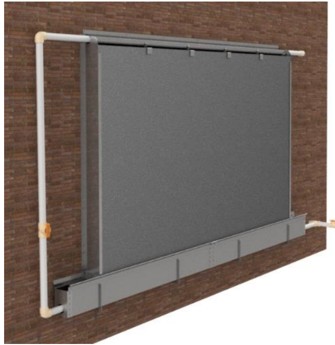
Figura 6 –Projeto do exterior do aviário com sistema Pad Cooling aplicado Fonte: Autores, 2019
