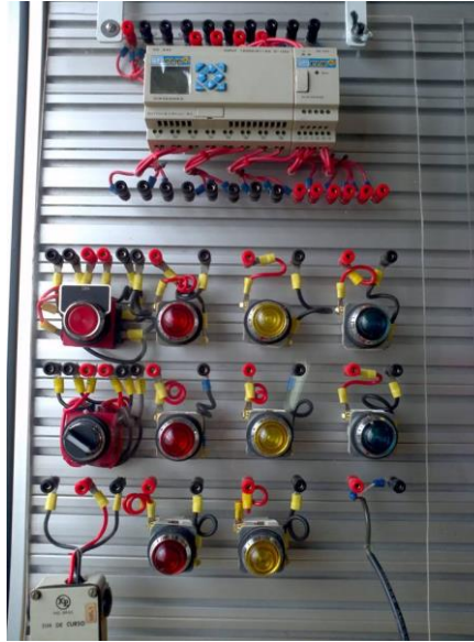
Figura 9 – Módulo 01 - módulo de CLP WEG Clic 02. Fonte: autores.
