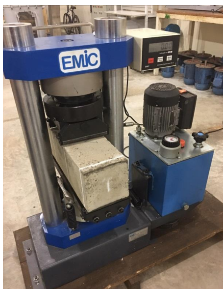
Figura 9 - Prensa hidráulica modelo EMIC (ensaio tração na flexão). Fonte: Arquivo pessoal
