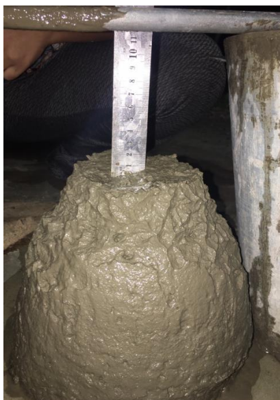
Figura 11 - Trabalhabilidade de 1% de fibra. Fonte: Arquivo pessoal
