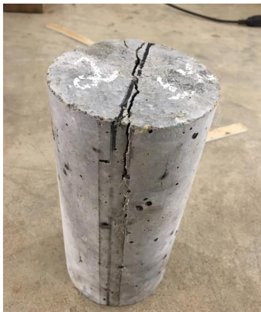
Figura 16 – Situação de ruptura do corpo de prova cilíndrico com 1% de fibra. Fonte: Arquivo pessoal
