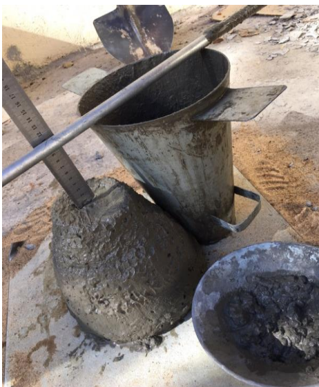
Figura 4 - Ensaio de consistência pelo abatimento de tronco de cone. Fonte: Arquivo pessoal
