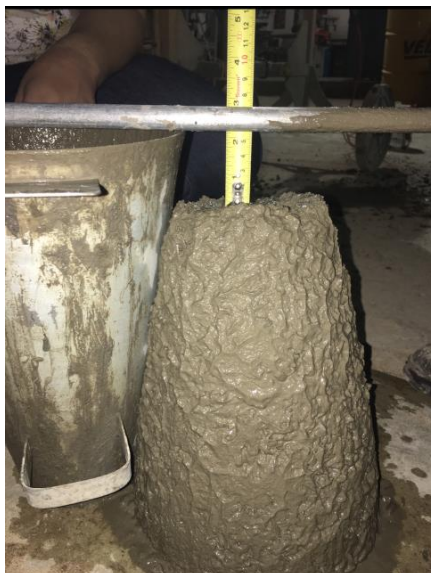
Figura 12 - Trabalhabilidade de 5% de fibra. Fonte: Arquivo pessoal
