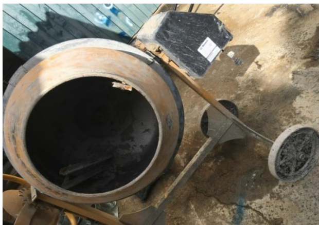
Figura 3 - Betoneira para mistura dos materiais. Fonte: Arquivo pessoal
