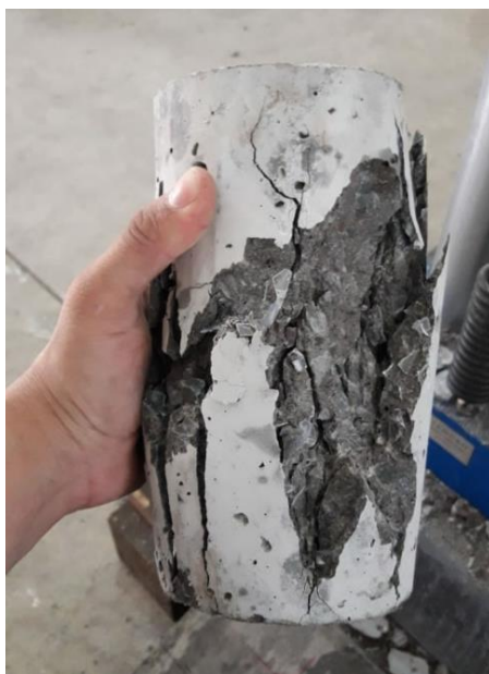
Figura 14 - Corpo de prova cilíndrico com 1% de fibra após ruptura. Fonte: Arquivo pessoal
