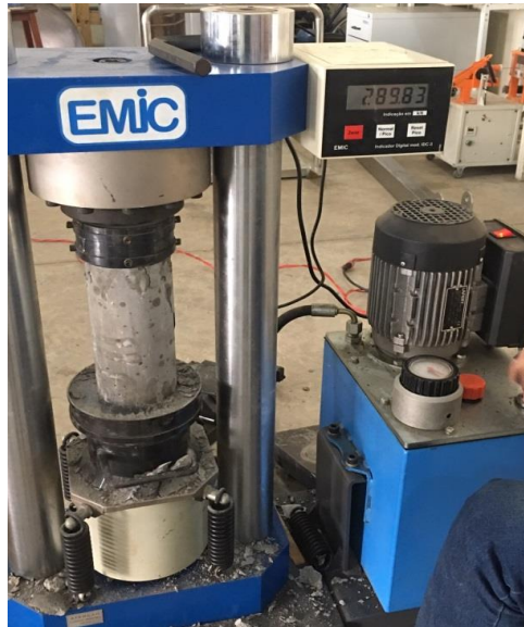
Figura 6 - Prensa hidráulica modelo EMIC (ensaio de compressão axial). Fonte: Arquivo pessoal
