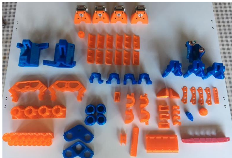
Figura 1: Peças impressas em plástico PLA. Fonte: Autor
