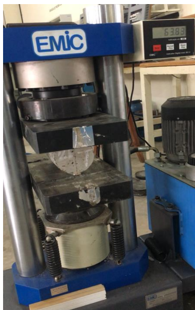
Figura 8 - Prensa hidráulica modelo EMIC (ensaio tração por compressão diametral). Fonte: Arquivo pessoal
