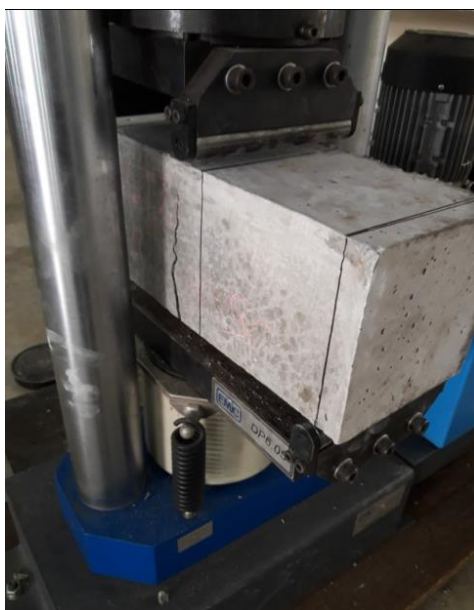
Figura 18 - Situação de ruptura do corpo de prova prismático com 1% de fibra. Fonte: Arquivo pessoal
