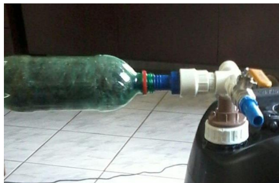
Figura 1 – Saída do biogás com filtro de impurezas.
