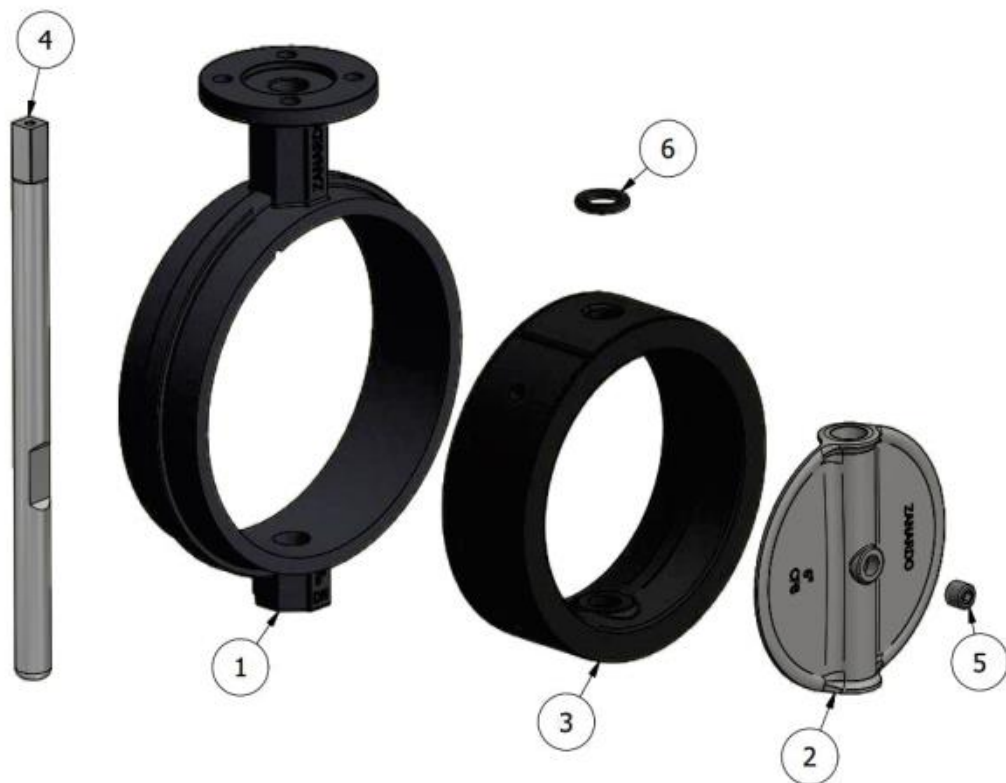
Figura 2 –Explosão de Componentes da Válvula Borboleta S208. Fonte: Próprio Autor.
