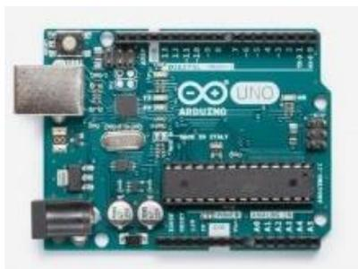
Figura 6 - Placa de Arduino.
