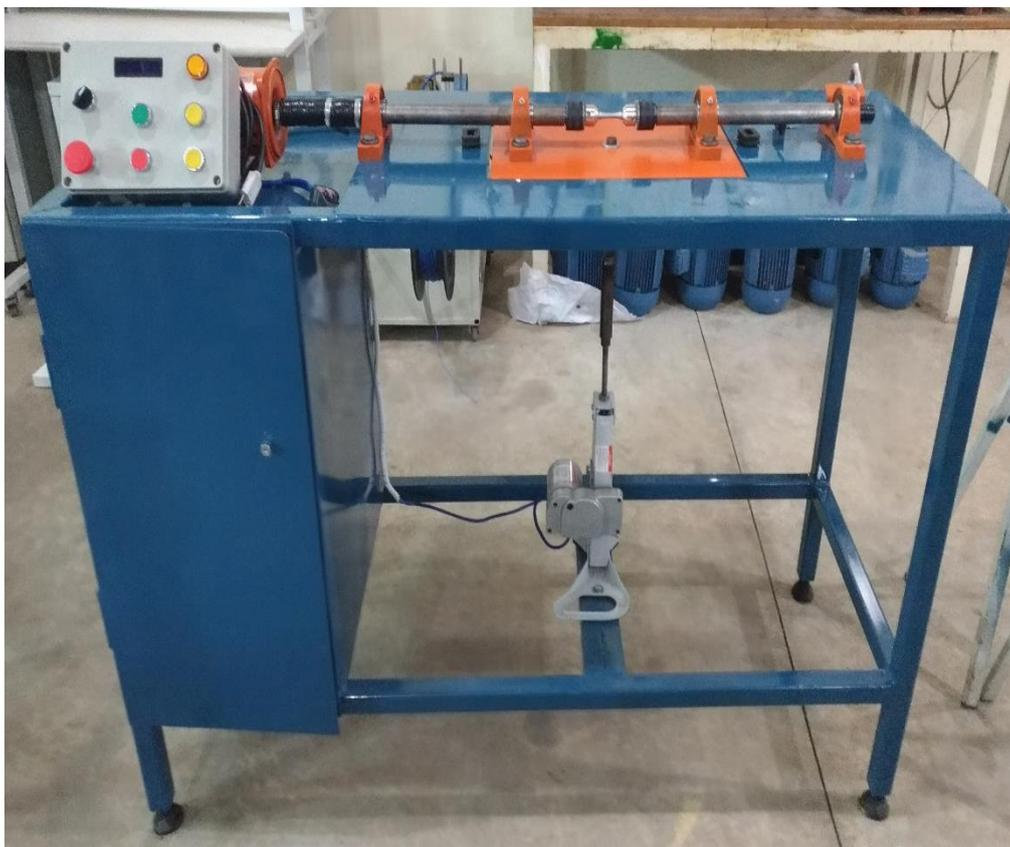
**Figura 8:** Máquina de ensaio de fadiga com seus componentes montados.
