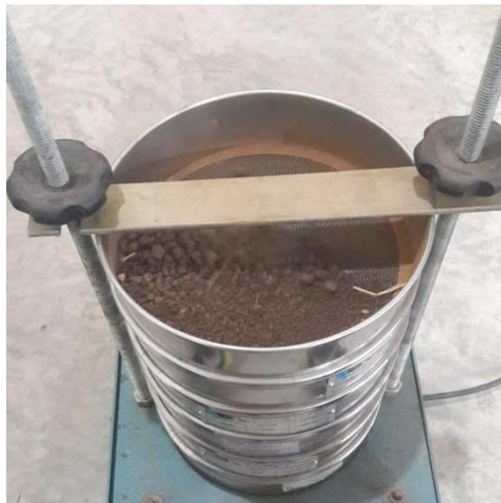
Figura 07: Agitador em funcionamento durante o ensaio
