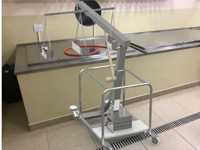
**Figura 7** – Projeto de modelagem do LiftDaver, posicionado no local de uso. Fonte: autores.
