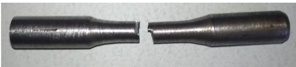
**FIGURA 10:** Corpo de prova rompido após ensaio de fadiga.
