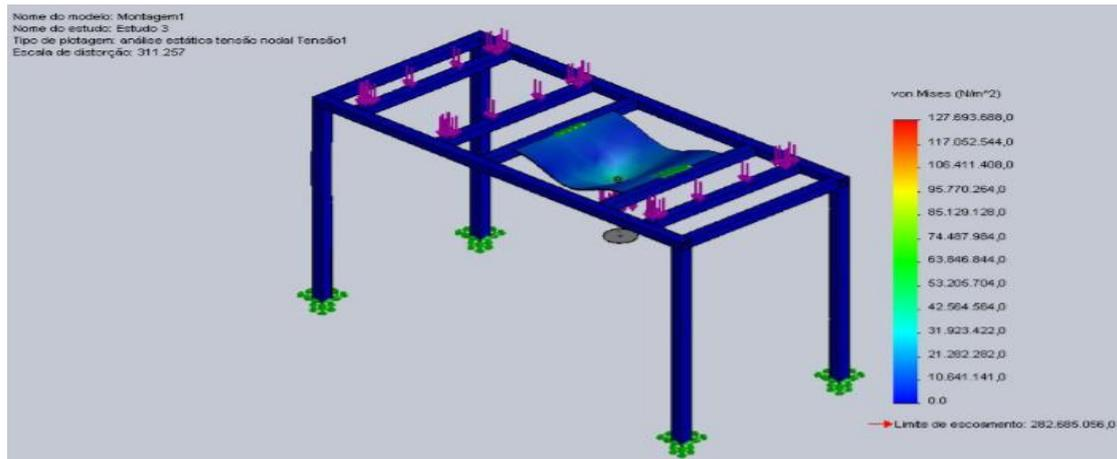
**Figura 6:** Ensaios da estrutura realizado via SolidWorks.
