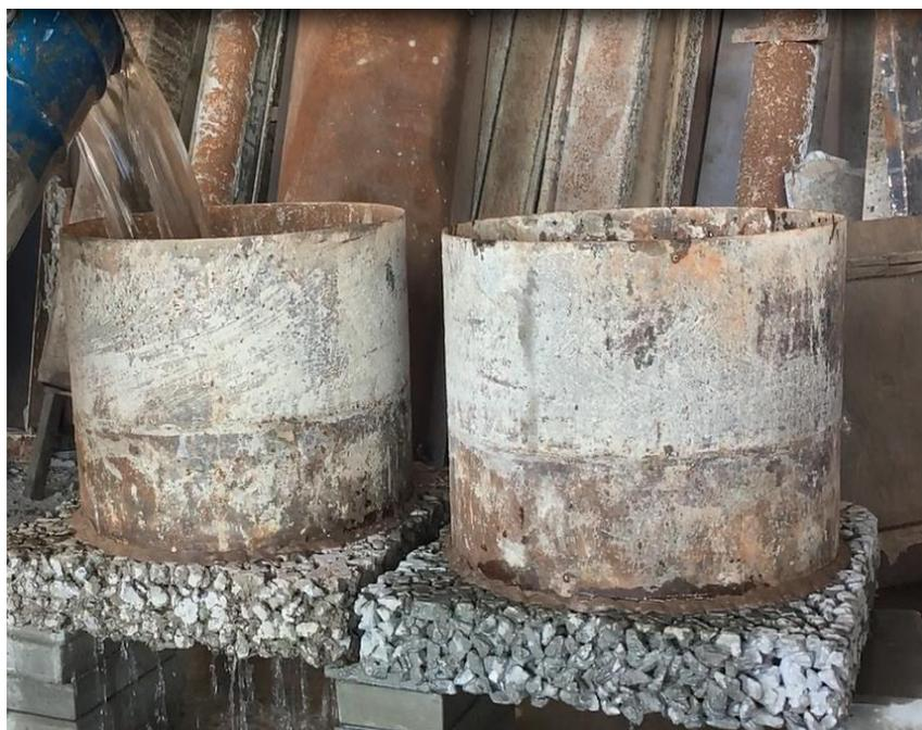
Figura 11: Tubulação unida com a placa de concreto permeável para recebimento de água
