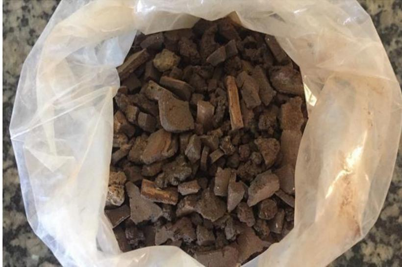
Figura 03: Resíduo de ETA após a secagem em estufa
