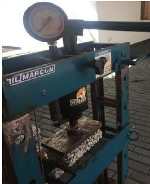
Figura 17: aplicação de força no piso com prensa hidráulica
