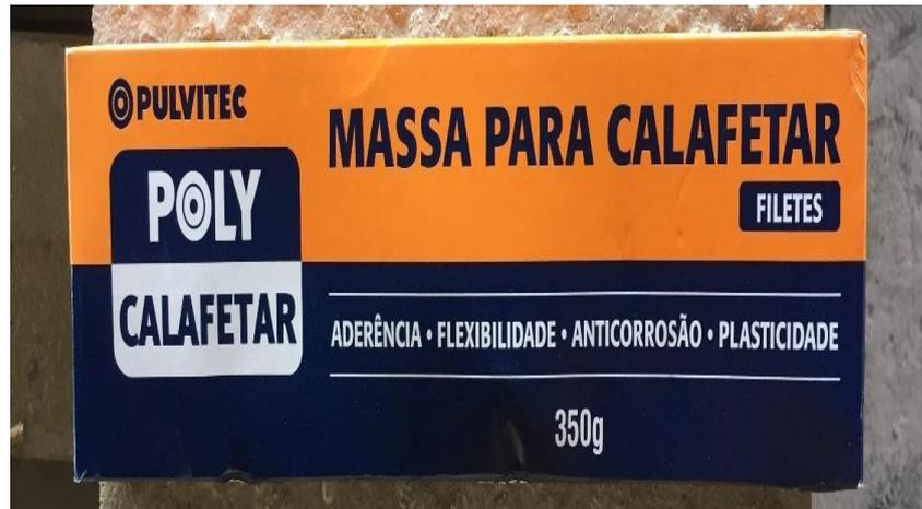
Figura 10: Massa de calafetar utilizada no ensaio
