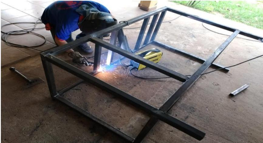
**Figura 7:** Montagem da estrutura da máquina de ensaio de fadiga.
