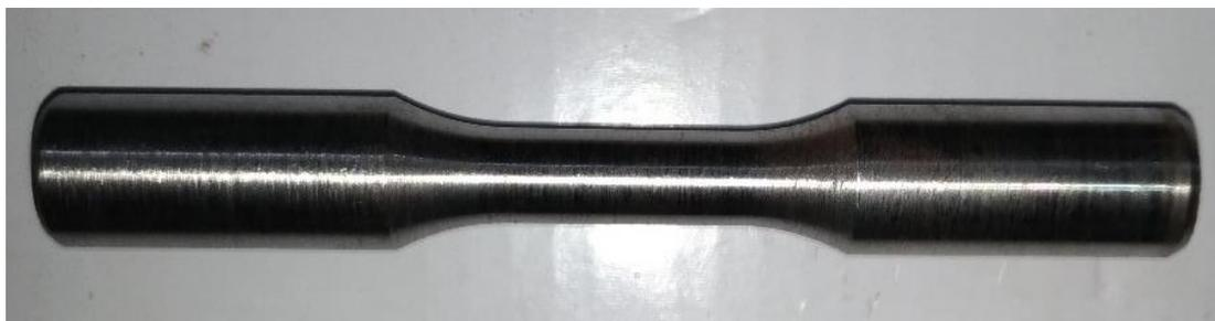
**FIGURA 9:** Corpo de prova utilizado no ensaio de teste do equipamento.
