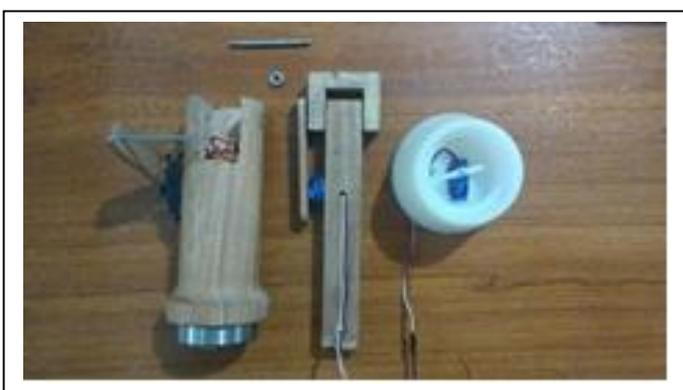
**Figura 1** – Braço, Ante-Braço com Pinça e Base (Da Esquerda para a Direita)
