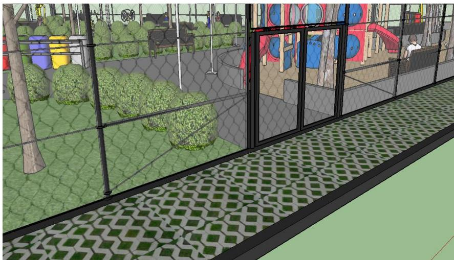
Imagem 5 : Pisograma e alambrado com grade losangular
