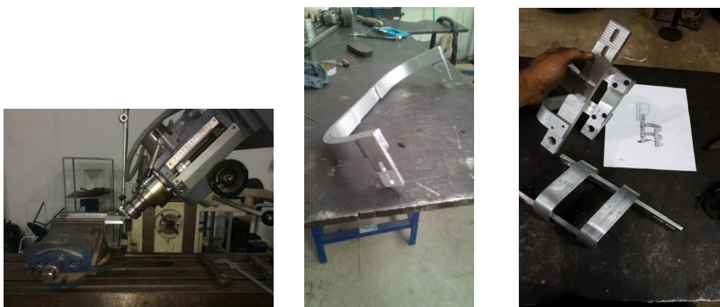
Figura 9 – Processo de fresagem, soldagem e acabamento. Fonte: autores.
