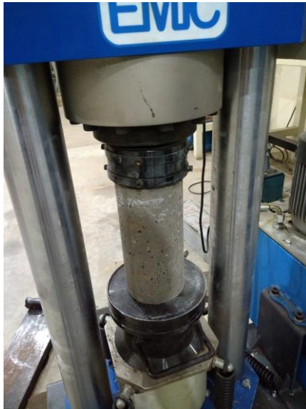
Figura 7 – Ensaio à compressão.
