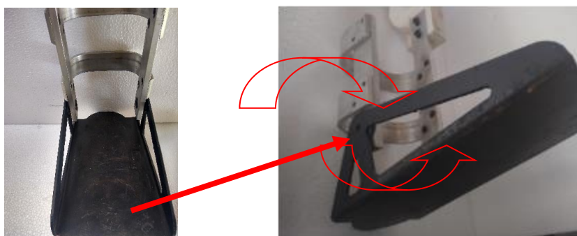
Figura 22 – Eixo de giro do pé. Fonte: autores.
