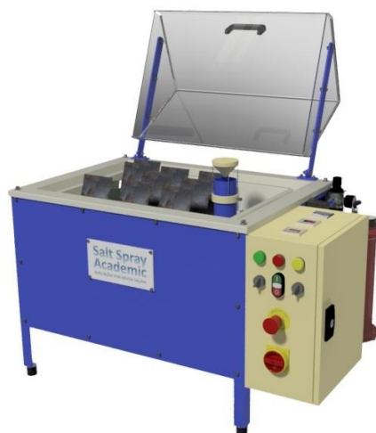
Figura 1 – Desenvolvimento da Câmara Salt Spray em Autodesk Inventor® Fonte: Autores, 2017.
