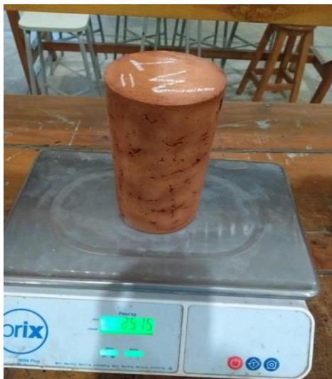
Figura 5 – Corpo de prova de solo cimento. Fonte: autores.
