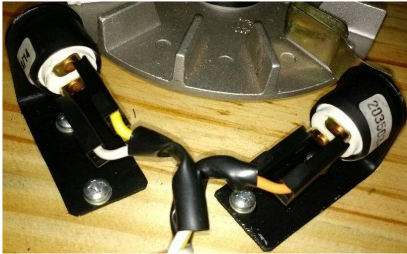
Figura 8 – Botões que realizam o sensoriamento da rotação. Fonte: autores.
