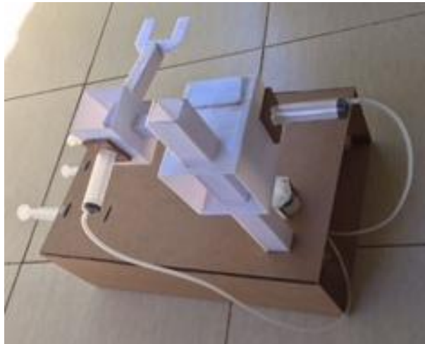
Figura 9 – Montagem do protótipo do manipulador cartesiano. Fonte: autores.
