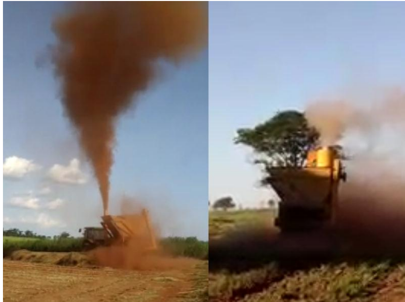
Figura 5 - Análise visual através das fotos da máquina trabalhando com rotação de 1600 rpm, sem o sistema de filtragem à esquerda e com o sistema à direita.
