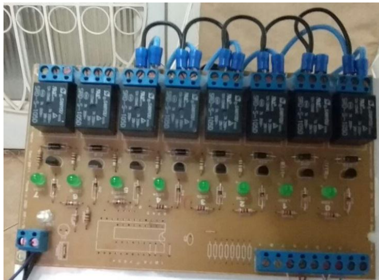
Figura 4 – Placa com relés shield . Fonte: autores.
