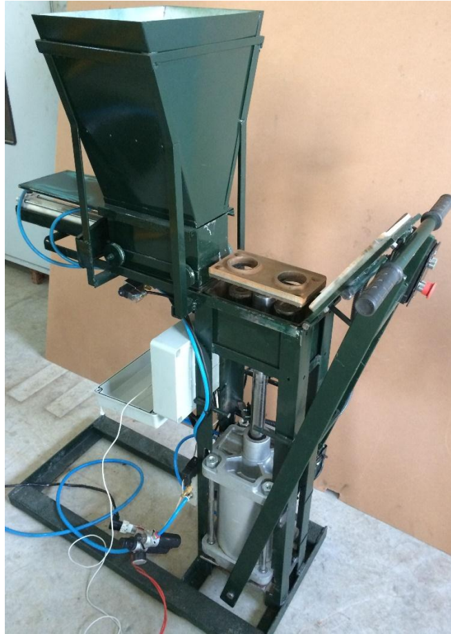
Figura 3 – Máquina de prensar tijolos ecológicos. Fonte: autores.
