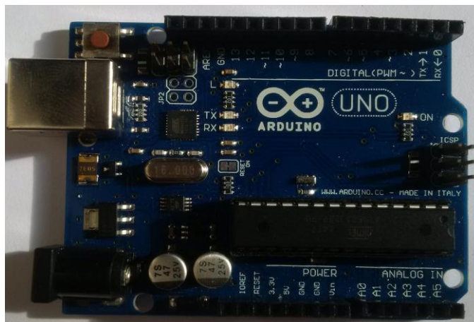
Figura 1 - Arduino Uno R3 AtMega328. Fonte: autores.
