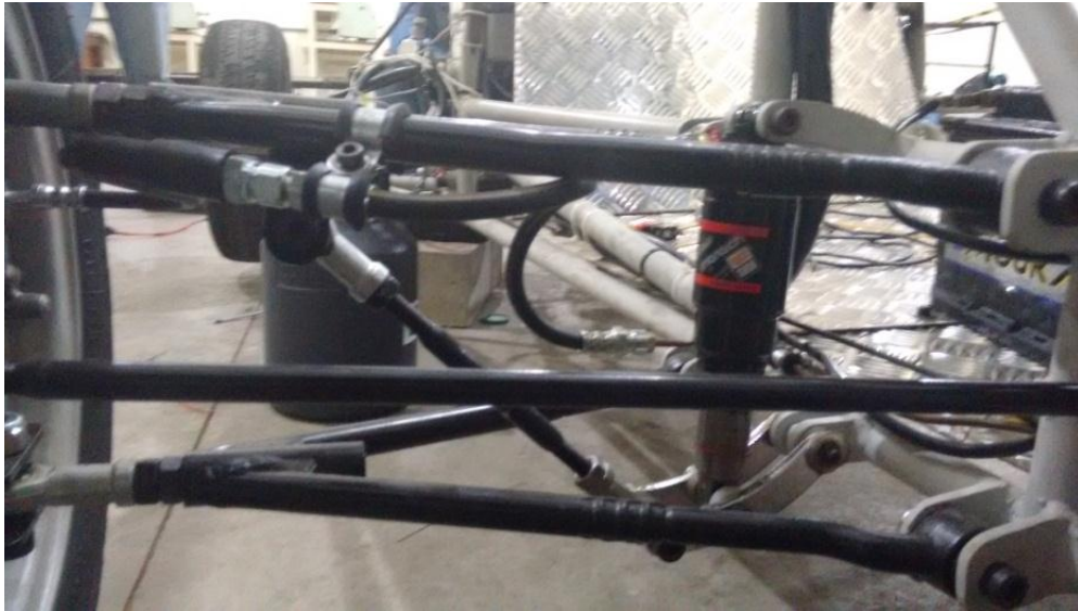
Figura 3 - Suspensão dianteira no sistema Pull Rod. Fonte: Autores.
