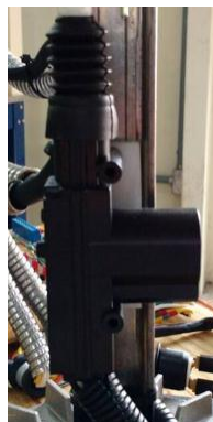
Figura 4 – Junta prismática que exerce as funções de elevação e descida. Revista eSALENG – Revista eletrônica das Engenharias do UniSALESIANO – Vol.2, n.1, 2017.
