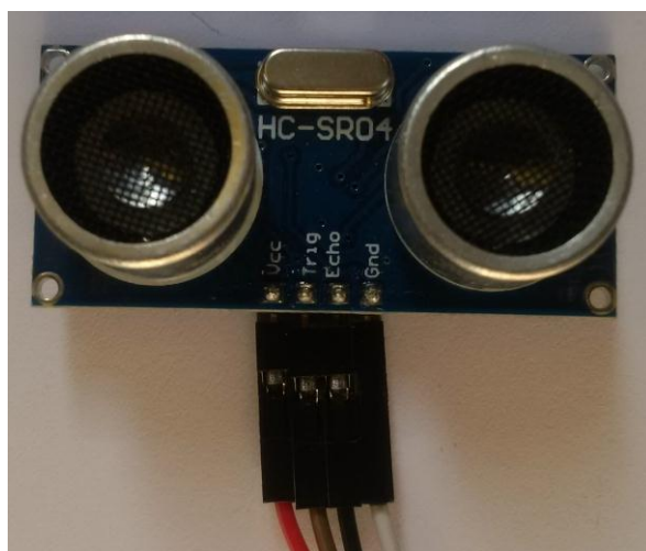
Figura 3 - Sensor Ultrassônico HC-SR04. Fonte: autores.
