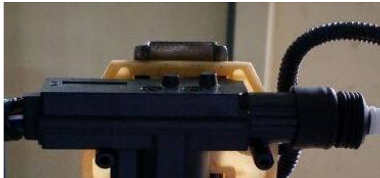
Figura 5 – Junta prismática que exerce o avanço e o recuo do braço. Fonte: autores.
