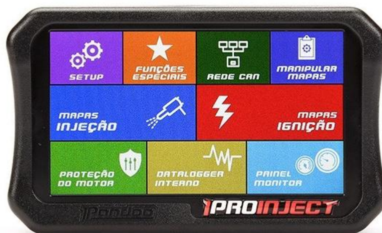
Figura 9 - Módulo de injeção eletrônica. Fonte: Autores.
