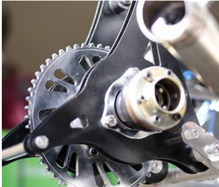
Figura 8 - Diferencial instalado. Fonte: Autores.
