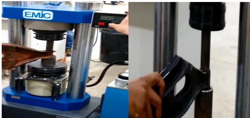
(5 A) (5 B) Figuras (5 A) e (5 B) – Análises de força para remoção das buchas. Fonte: autores.
