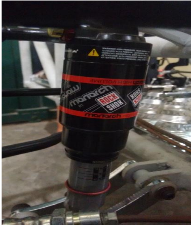
Figura 2 - Amortecedor utilizado nas suspensões. Fonte: Autores.
