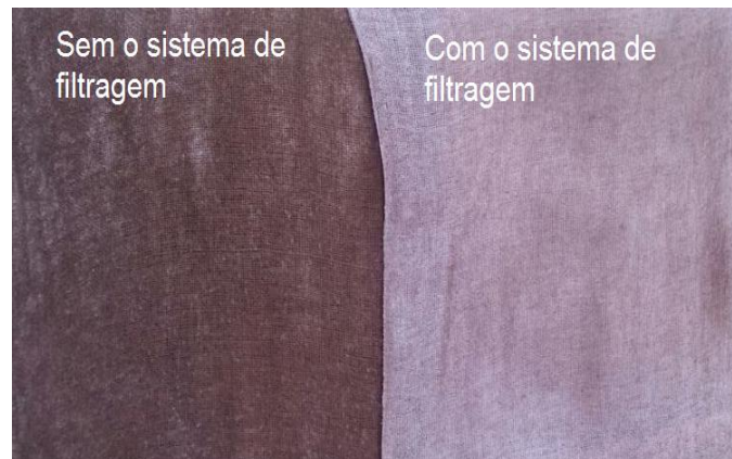
Figura 4 - Análise de emissão de material particulado com tecido de algodão branco e umedecido.
