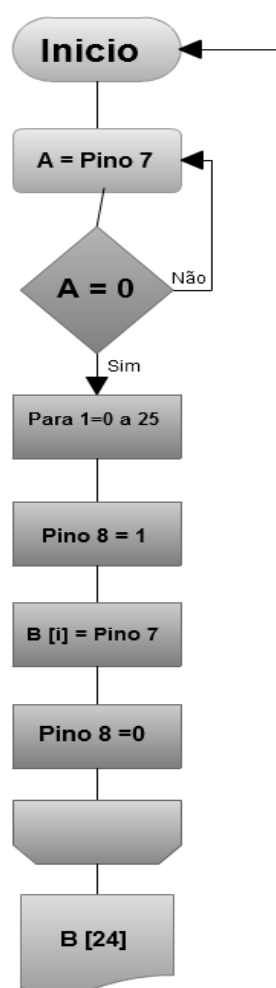
Figura 2 – Fluxograma do sinal digital no Arduino. Fonte: autores.
