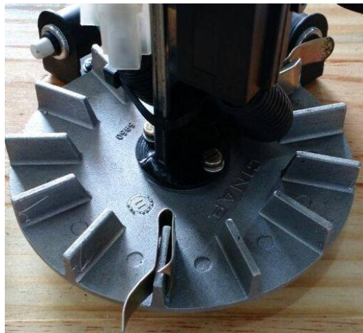
Figura 3 – Junta rotacional atuante na base do braço robótico. Fonte: autores.
