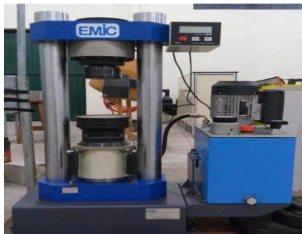
Figura 4 - Equipamento de ensaio de compressão. Fonte: autores.
