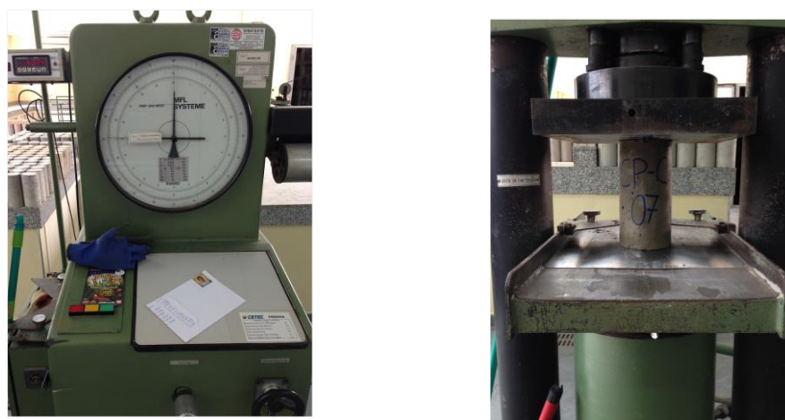
Figura 2 – Máquina de ensaio à compressão diametral e axial. Fonte: autores.
