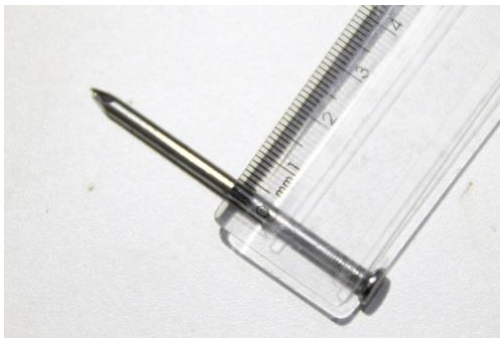
Figura 9 - Pino de 3,2 mm para o ensaio de dobramento das fibras. Fonte: autores.
