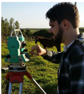
Figura 10 – Configuração da estação total. Fonte: autores.
