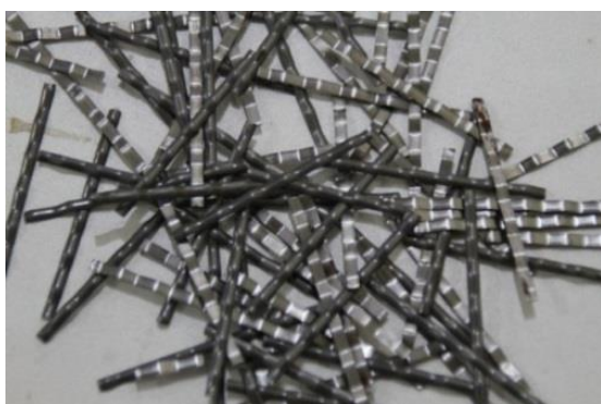
Figura 2 – Fibras metálicas corrugadas do tipo C-III. Fonte: autores.
