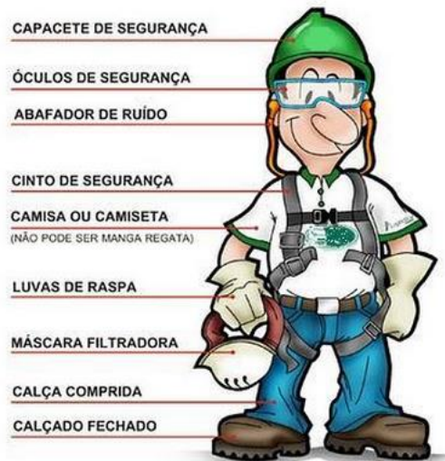
Figura 4 - EPI's necessários para execução de trabalhos de risco. Fonte: Empresa JVL Andaimos. Disponível em jlvandaimos.blogspot.com.br
