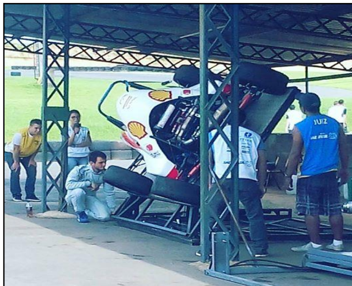
Figura 7 – Veículo da Fórmula SAE da equipe Sale Racing, passando por teste em TiltTable da organização da competição e, posteriormente, aprovado. Fonte: autores.
