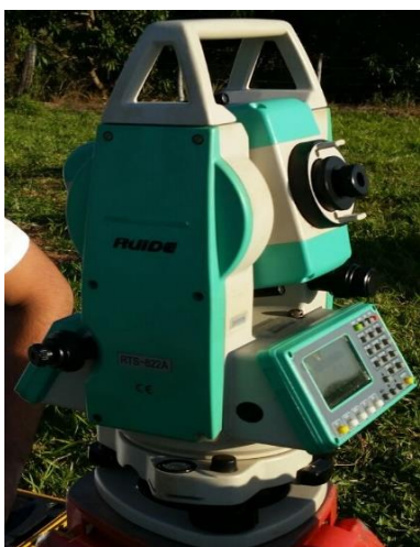
Figura 1 – estação total Ruide RTS 820. Figura 2 – GPS Ashtech ProMark 2. Fonte: autores
