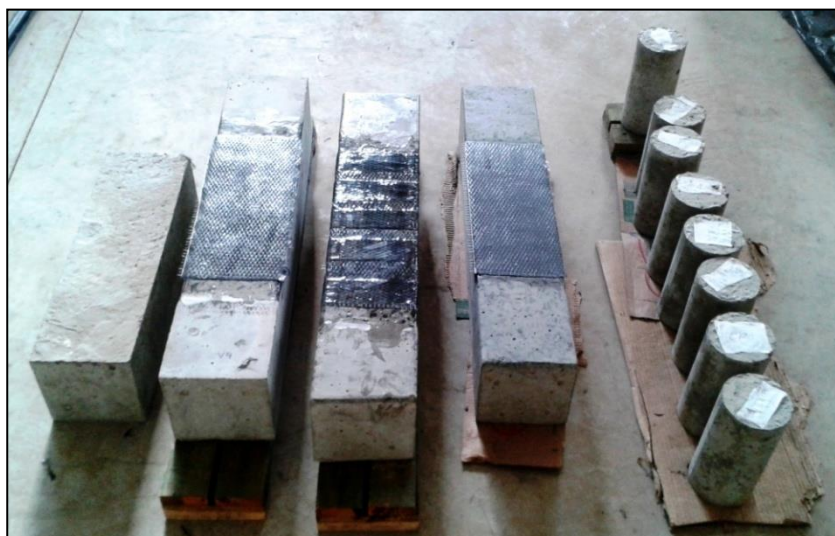
Figura 13 – Vigas reforçadas e CP's cilíndrico. Fonte: autores.
