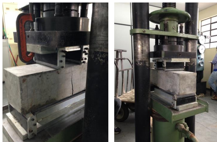
Figura 3 – Ensaio de tração na flexão com corpo de prova prismático. Fonte: autores.
