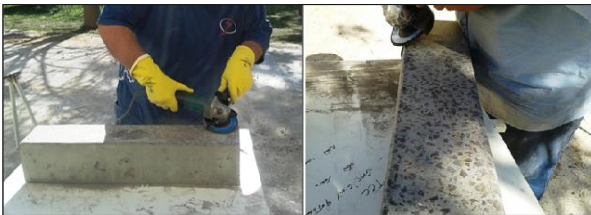
Figura 5 - Retirada da nata e arredondamento dos cantos. Fonte: autores.
