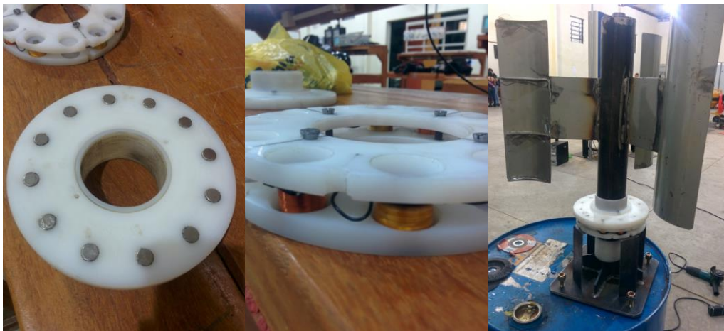
Figura 6 – a) Disposição dos ímãs de neodímio; b) Fixação das bobinas; c) Fixação da placa de ímã e bobinas no rotor. Fonte: Própria.
