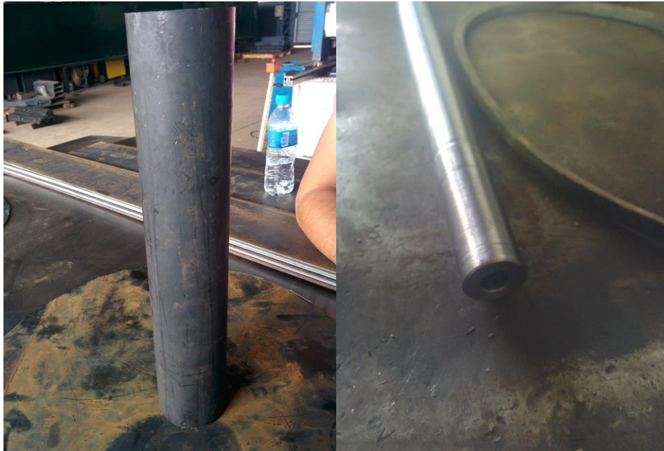
Figura 3- a) tubo mecânico em aço ABNT 1020; b) eixo fixo rotor em aço ABNT 1045. Fonte: Própria.
