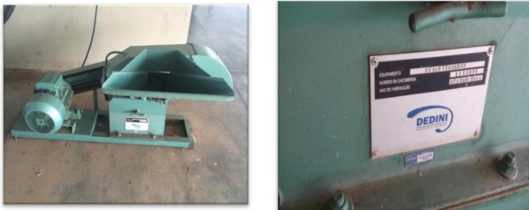
Figura 1: Desintegrador utilizado para triturar a casca do coco e seus respectivos dados de fabricação.
