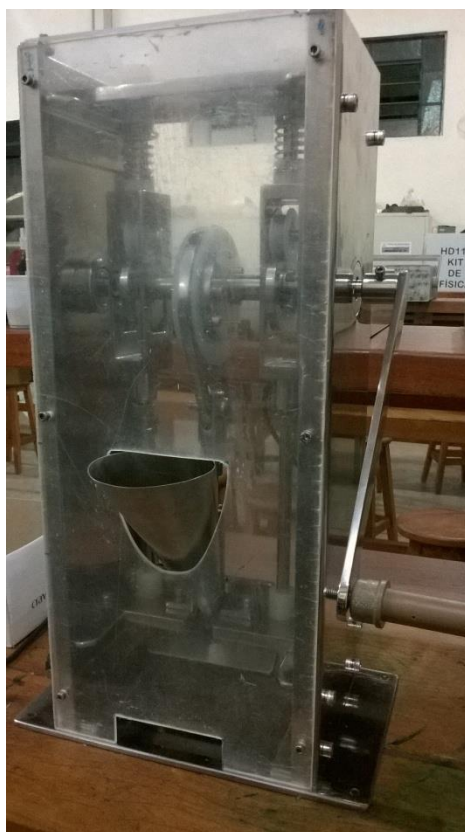
Figura 7 - MCC na bancada do Laboratório de Engenharias e Arquitetura do Unisaesiano Araçatuba, com as proteções em acrílico instaladas. Fonte: autores.
